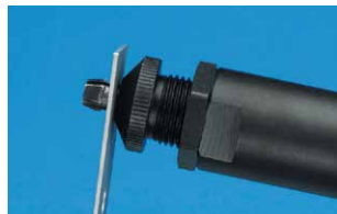
Inserta el punzón (fijo a la herramienta 74290) dentro de taladro circular
